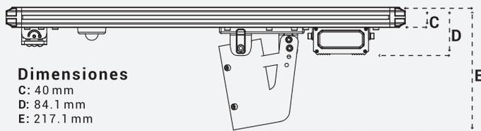
\*LUMINARIA COMPLETA CON ENSAMBLE Y FIJACIÓN EN TORNILLERÍA EN ACERO INOXIDABLE CON PROTECCIÓN ANTIVANDÁLICA.
